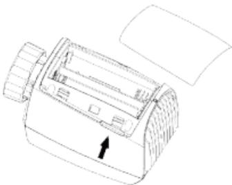
Die Lebensdauer der neuen Alkalibatterien beträgt etwa 1,5 Jahre. Das Symbol der Batterien (BAT) auf dem Display bedeutet, dass die Batterien zu ersetzen sind. Nach dem Herausnehmen der ausgeladenen Batterien warten Sie etwa 1 Minute, bevor Sie neue einlegen. Dieses Gerät unterstützt die Nutzung der wiederaufladbaren Batterien.
