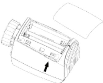
Životnost nových alkalických baterií je zhruba 1,5 roku. Symbol baterií ( ) na displeji znamená, že je nutné baterie vyměnit. Poté, co vyjmete vybité baterie, počkejte zhruba 1 minutu, než vložíte nové. Toto zařízení nepodporuje použití dobíjecích baterií.
