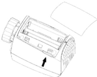
Životnosť nových alkalických batérií je zhruba 1,5 roka. Symbol batérie (bAt) na displeji znamená, že batérie treba vymeniť. Po vybratí vybitých batérií cca 1 minútu počkajte, kým vložíte nové. Toto zariadenie nepodporuje používanie dobíjacích batérií.
