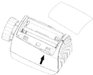
Wytrzymałość nowych baterii alkalicznych porusza się w granicach 1,5 roku. Symbol baterii (**BAT**) na wyświetlaczu oznacza, że baterię trzeba wymienić. Po tym, co wyjmiesz wyladowane baterie, oczekaj mniej więcej 1 minutę zanim włożysz nowe. Niniejsze Urządzenie nie wspiera użycia akumulatorów do wielokrotnego ładowania.
